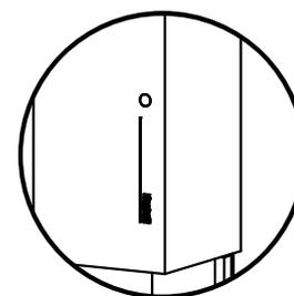
La lumière bleue du "voyant" indique l'éclairage correct de la lampe UV-C. Le remplacement de la lampe doit se faire quand la lumière bleue ne s'allume plus lorsque le produit fonctionne.
