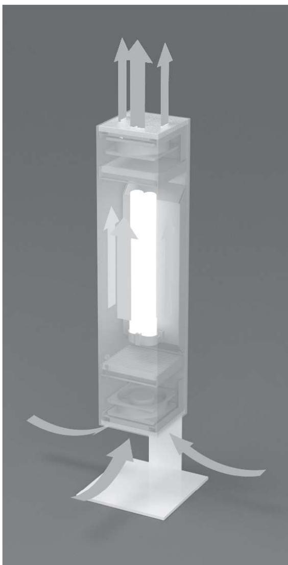
L'unité de désinfection se compose d'un système d'admission de ventilateur axial qui aspire l'air à l'intérieur de la chambre fermée contenant la source UV-C, où le processus de désinfection a lieu. La cartouche remplaçable uvOxy<sup>®</sup> est installée à l'intérieur du module. Le remplacement est rapide et garantit les caractéristiques de désinfection de l'appareil sont maintenus dans le temps. Utilisez une pièce de rechange uvOxy<sup>®</sup> Beghelli d'origine (code 26720).
