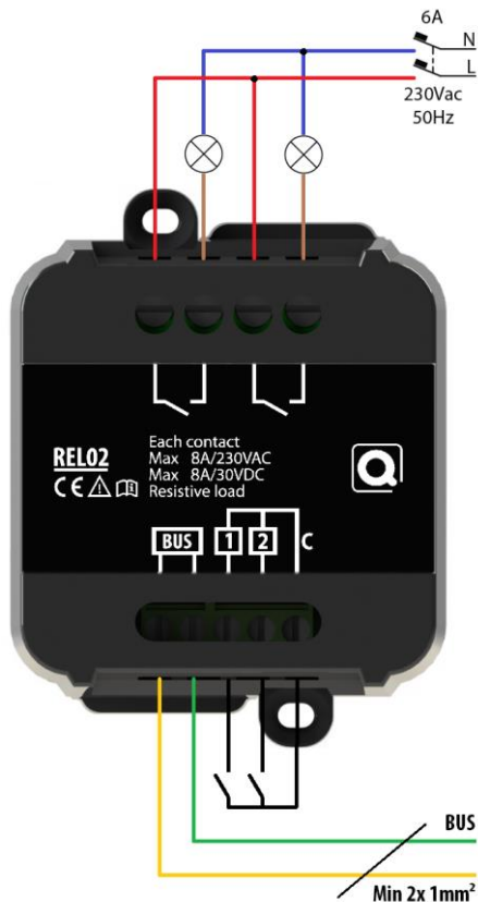
Figuur 2 : Aansluitvoorbeeld van de voeding en de belastingen
