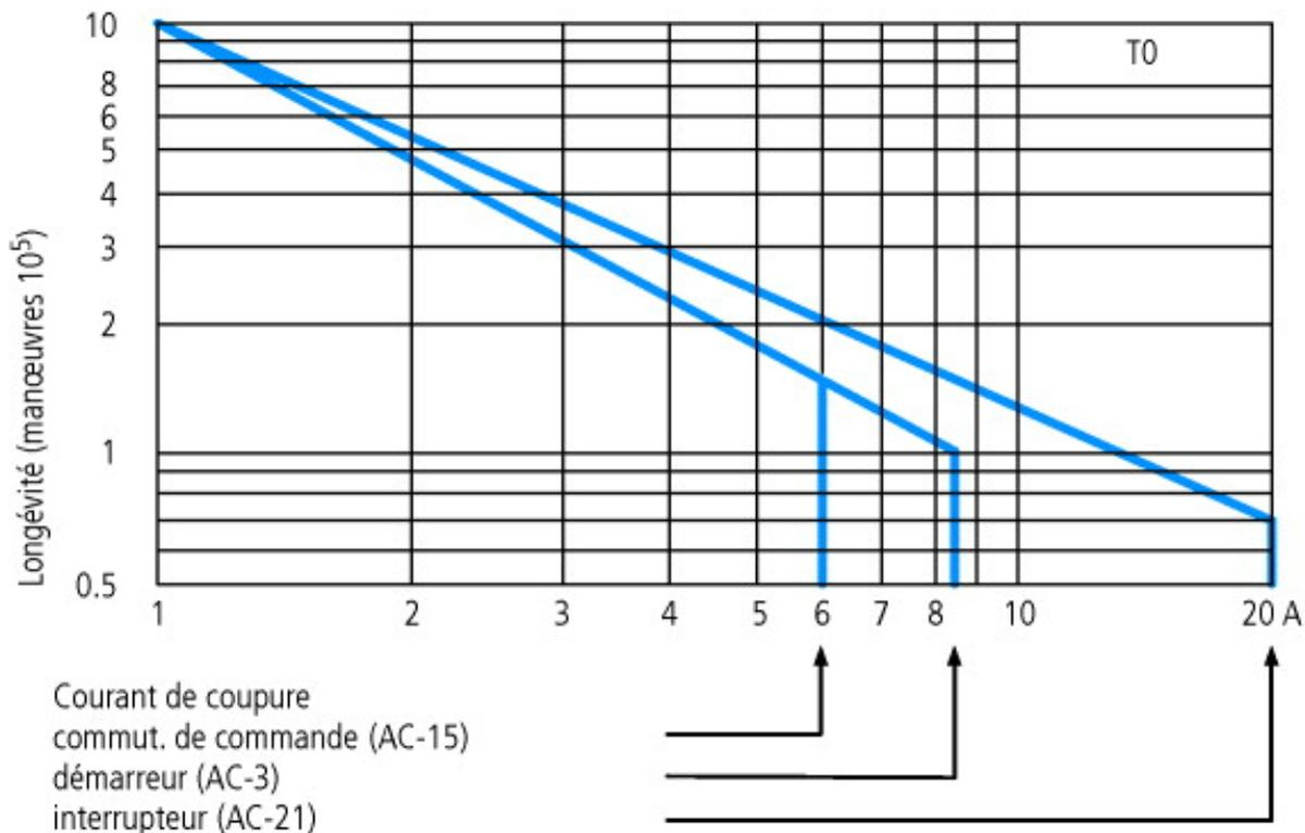
Pour catégorie d'emploi AC-4 (charge extrême : 100 % marche par à-coups, inversion brutale ou freinage par contre-courant) le courant de calage du moteur ne doit pas être supérieur au courant assigné du commutateur pour AC-21A.
