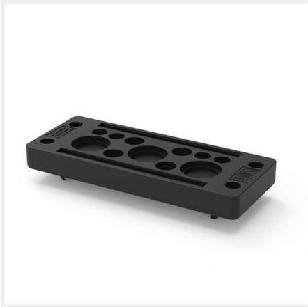
**Description:** Entrée de câbles plastique pour une utilisation rapide, économique et sans outils. Pour l'entrée de câbles ou de gaines pneumatiques à l'intérieur de l'armoire. Joint intégré. Pour attache par clips et/ou vissage. Le système à clips fonctionne sur des parois de 1,5 à 2 mm d'épaisseur. Hauteur de pose: 15,5 mm.
