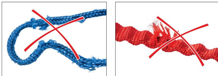
Figure 14: Retirez les composants KNIPEX TetheredTools du système de fixation s'ils sont endommagés
