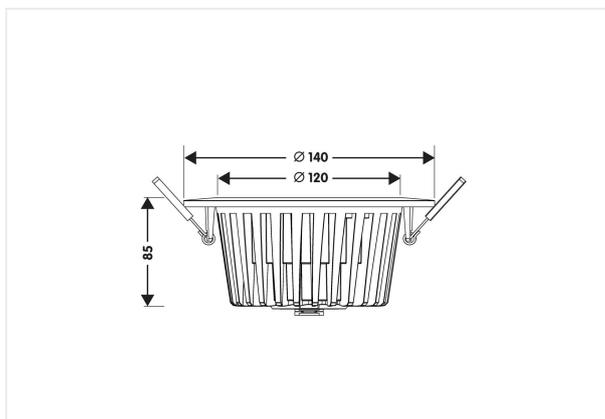
Downlight avec module Led CREE remplaçable. Fourni avec alimentation muni d'une connexion 'plug and play' pour une installation facile et rapide.
