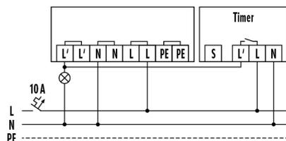
Raccordement en parallèle sur minuterie.
