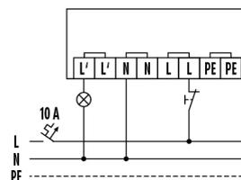
Raccordement avec commande optionnelle par poussoir.
