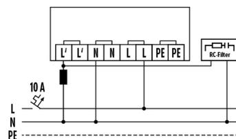
Raccordement en parallèle de 6 appareils au maximum.
