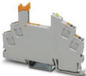
Embase de relais RIF-0..., pour relais de puissance miniatures avec 1 contact NO ou relais à semi-conducteurs similaires, raccordement Push-in, montage sur NS 35/7,5
