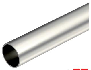
Tube d'installation électrique sans extrémités filetées selon la norme EN 61386-1, pour la protection mécanique de câbles et de conducteurs. Avec paroi intérieure sans ébarbure. Classe de protection anticorrosion 4 (élevée).
