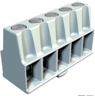
Bornes et vis en acier, galvanisées (passivation transparente), section nominale 1,5 ÷ 6 mm², tension nominale 400 V, à 5 pôles, avec bornes à douilles, sections de raccordement maximales par point de raccordement: 3x6 mm², 4x4mm² ou 6x2,5 mm².
