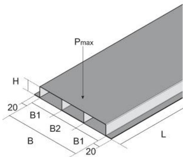
La gaine de sol fermée à section rectangulaire est fabriquée en tôle d'acier galvanisée Sendzimir. La gaine de sol est divisée en 3 compartiments par deux cloisons de séparation. Les parties supérieures et inférieures sont solidement assemblées. Les trous de forage intégrés dans le rebord serti facilitent la fixation au plancher avec des chevilles à frapper UN 5/38. Conforme NBN EN 50085
