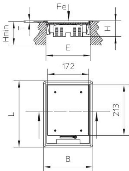
Le rebord, le couvercle autofermant avec sortie latérale et le levier autofermant sont fabriqués en polyamide, d'une couleur gris mat et noir mat.
