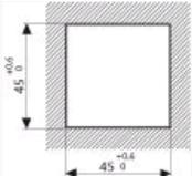
Schéma Encadrement : 26546841 - Adaptateur rail DIN
