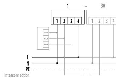
Raccordement sur 230 V. Option possible : mise en réseau de 30 détecteurs max. / relais PROTECTOR K (max. 300 m de câblage)
