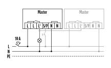
Raccordement standard avec commande en option par bouton-poussoir et utilisation de 6 appareils esclaves maximum sur un appareil maître.
