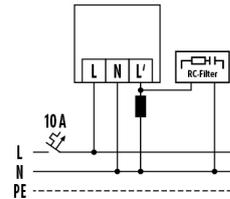
Raccordement d'inductances (par ex. relais, contacteur, ballast) peut nécessiter l'insertion d'un filtre RC (A).
