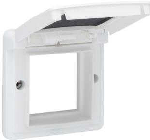
Ce cadre d'adaptation est utilisé pour encastrer des fonctions 45 x 45 mm dans des boîtes en saillie étanches aux projections d'eau. Il convient pour des modules de données, des prises téléphoniques, des prises audio et des prises TV/FM. Il est muni d'un clapet de protection à charnières. Combinaison de couleurs: white.
