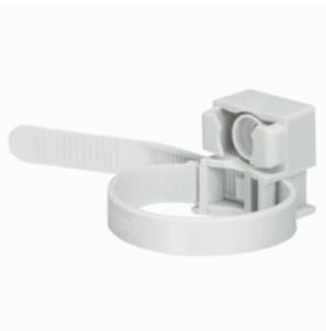
Collier à embase - pour utilisation intérieure - polyamide - gris - réglable pour tubes de 5/8" à 1 1/4" (CEI 16 à 32) ou câbles diamètre de 15 à 30 mm
