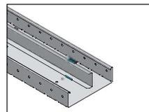
Placer le verrou dans l'emplacement voulu dans la perforation du fond et encliqueter la cloison de séparation.
