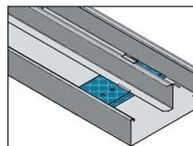
Placer l'étrier de fond dans la gaine à câbles, le verrou dans l'emplacement voulu dans la perforation de l'étrier de fond et encliqueter la cloison de séparation.
