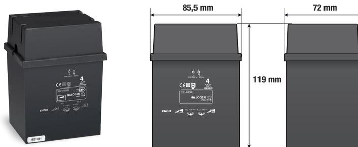
Ce bloc transformateur ferromagnétique a une puissance de 105 W. Il convient au raccordement de lampes basse tension (LED 12 V). Vous pouvez ensuite faire varier l'intensité lumineuse de ces lampes au moyen de contrôle de phase et de variateurs universels. Le transformateur se raccorde au moyen de deux bornes à vis du côté primaire et de quatre bornes à vis du côté secondaire. Il possède un degré de protection IP20. Les pieds de fixation sont fournis.
