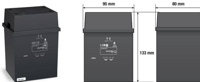
Ce bloc transformateur ferromagnétique a une puissance de 150 W. Il convient au raccordement de lampes basse tension (LED 12 V). Vous pouvez ensuite faire varier l'intensité lumineuse de ces lampes au moyen de contrôle de phase et de variateurs universels. Le transformateur se raccorde au moyen de deux bornes à vis du côté primaire et de quatre bornes à vis du côté secondaire. Il possède un degré de protection IP20. Les pieds de fixation sont fournis.
