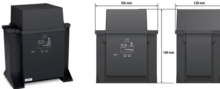
Ce bloc transformateur ferromagnétique a une puissance de 400 W. Il convient au raccordement de lampes basse tension (LED 12 V). Vous pouvez ensuite faire varier l'intensité lumineuse de ces lampes au moyen de contrôle de phase et de variateurs universels. Le transformateur se raccorde au moyen de deux bornes à vis du côté primaire et de quatre bornes à vis du côté secondaire. Il possède un degré de protection IP20. Les pieds de fixation sont fournis.
