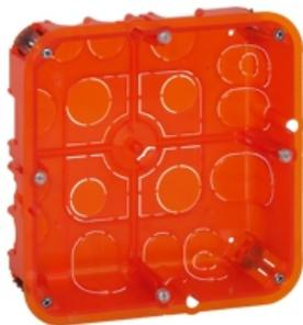
Batibox boîte d'encastrement grand format - 2 x 2 postes ou 2 x 4/5 modules - profondeur 50 mm - dimensions 142 x 142 mm - utilisable en cloisons creuses
