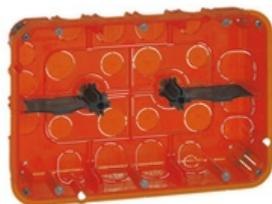
Batibox boîte d'encastrement grand format - 2 x 6 modules - profondeur 50 mm - dimensions 213 x 142 mm - aussi utilisable en cloisons creuses
