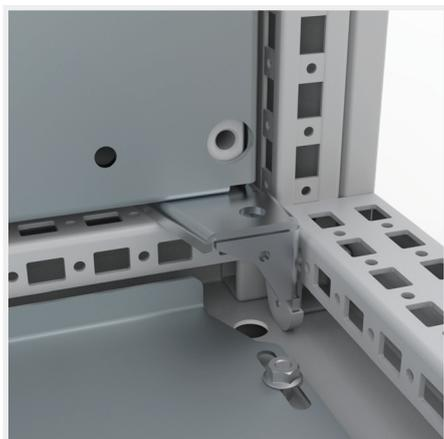
**Description:** Pour fixer les platines de montage tout au fond de l'armoire, avec des équerres permettant de régler la profondeur au pas de 25 mm. Ces supports sont nécessaires lorsqu'une plaque de fixation supplémentaire doit être montée ou lorsque l'armoire est livrée sans plaque de fixation (PE).
