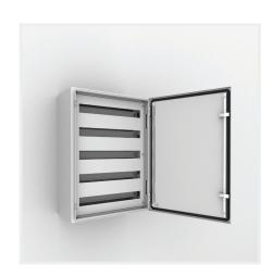
**Description:** Pour monter facilement les appareils modulaires d'une hauteur maximale de 68 mm. Distance entre rangées: 125 mm. Au besoin, la porte standard de l'armoire peut être remplacée par une porte vitrée. Profondeur utile entre le couvercle avant et la porte extérieure: 35 mm. Dans les armoires en acier inox, un usinage sera nécessaire.
