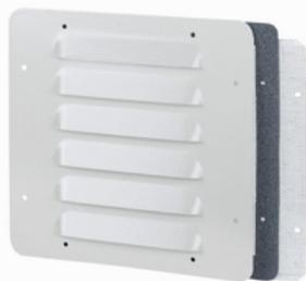
Ouïe d'aération métallique pour coffrets et armoires - dimensions 248 x 248 mm - RAL 7035 - IP 32 - IK 10 - livré avec une paire de grilles anti-insectes
