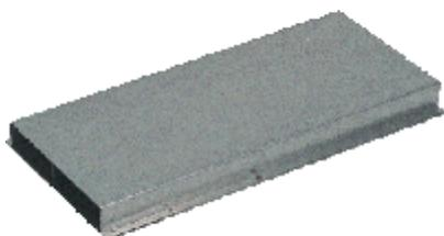
Van Geel GVG-5 - gaine de sol noyée - sendzimir - élément de plancher - hauteur 38 mm - longueur 3000 mm - comp. 2 - épaisseur 0,75 mm - largeur 190 mm
