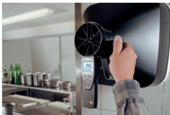
testo 417, par ex. pour le contrôle de ventilation en extraction d'air
