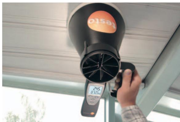
testo 417, par ex. pour le contrôle de ventilation en apport d'air neuf
