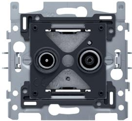
Mécanisme pour 2 connexions coaxiales simples : une pour la télé et l'autre pour la FM, avec fixation par griffes. Les mots 'TV' et 'FM' sont gravés à côté des entrées. Un set de finition d'une couleur au choix doit être commandé séparément.
