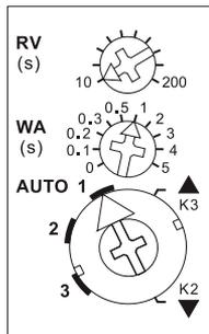
**AUTO 1** = Dans cette position de l'interrupteur inférieur la fonction d'inversion confort pour jalousies locale est **enclenchée**. Dans le cas de la commande locale avec un poussoir aux bornes A3+A4 (à pointer) ou d'un poussoir double aux bornes A5/A6 génère une impulsion double pour un enroulement lent dans le sens contraire et
