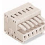
Connecteur femelle; 6 pôles; Pas 3,5 mm / 0.138 in; 100% protégé contre l'inversion; avec possibilité de codage
