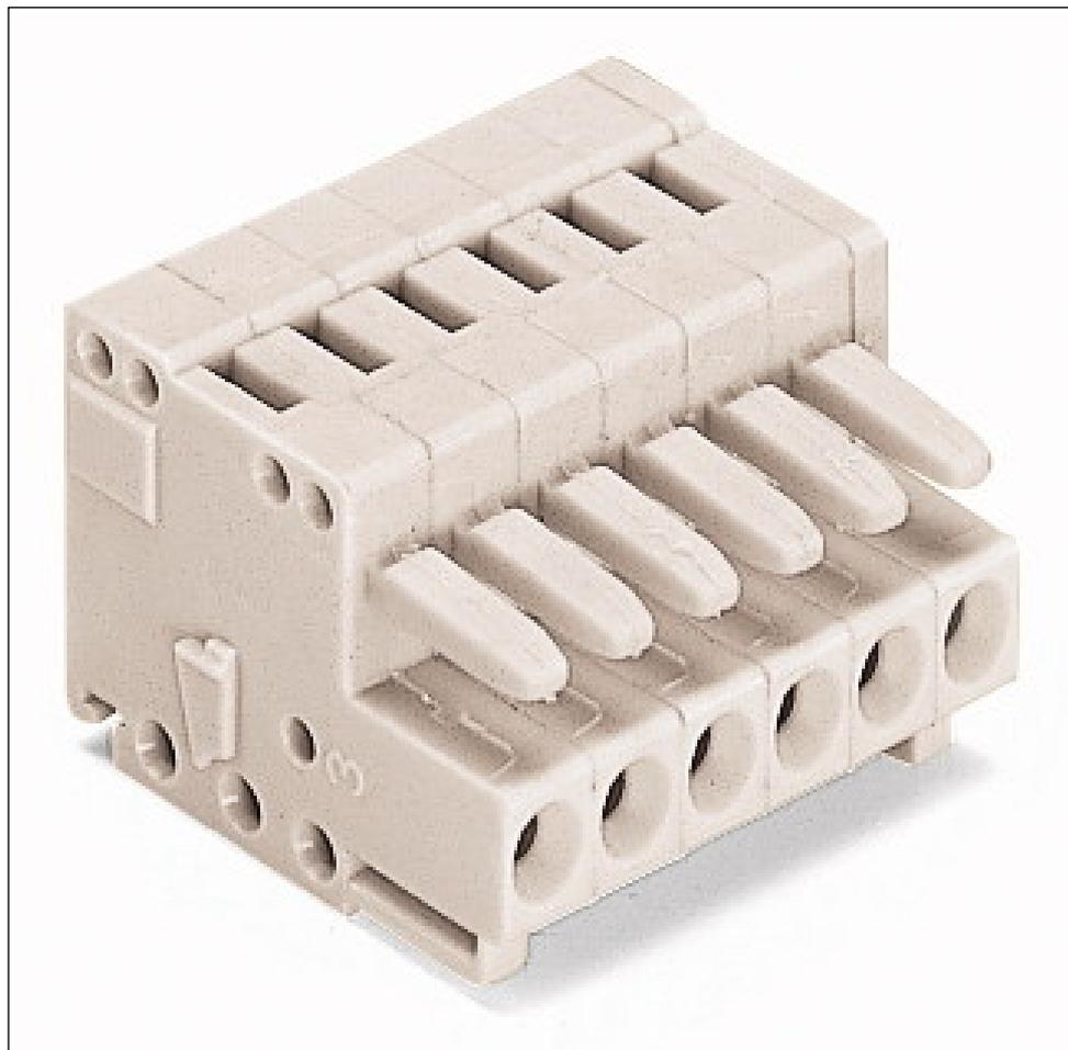
Aperçu d'impression: Connecteur femelle; 6 pôles; Pas 3,5 mm / 0.138 in; 100% protégé contre l'inversion; avec possibilité de codage - Numéro d'article: 734-106
