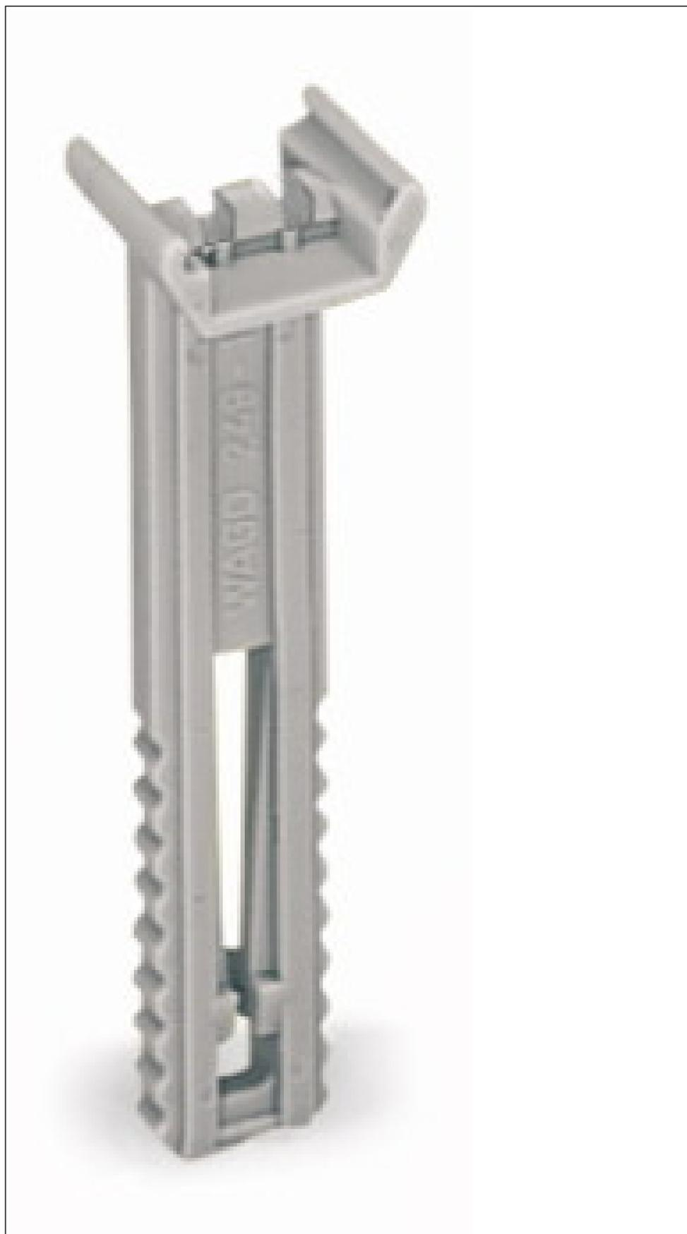
Aperçu d'impression: Porte-étiquettes de groupe ajustable en hauteur; pour 2 étiquettes WMB ou 1 profil de repérage; largeur 10 mm; encliquetable et réglable en hauteur de 43,5 mm à 59,5 mm sur butées d'arrêt 249-116 et 249-117; support d'étiquettes : WMB, WSB, WCB - Numéro d'article: 249-118
