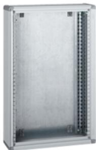
**Coffret de distribution XL<sup>3</sup> 400 métal - hauteur 1500 mm - largeur 575 mm - profondeur 175 mm - IP 43 - IK 08 avec kit et porte - gris RAL 7035**
