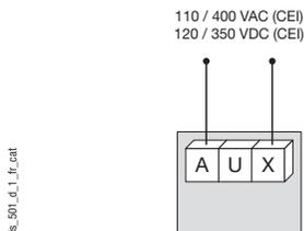
Il est conseillé de protéger l'alimentation auxiliaire par l'utilisation de fusibles gG 500 mA.
