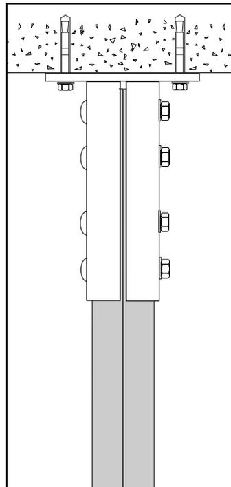
Utilisez une base pour pendent 520 pour le montage d'un profilé de suspension 24/20 sur le sol ou contre le plafond.
