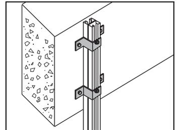
Le profilé de suspension 24/20 peut être fixé à une poutre ou au mur avec des étriers muraux 20.
