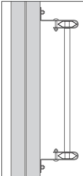
L'échelle à câbles peut être installée verticalement ou horizontalement sur le profilé 24/20 à l'aide d'étriers muraux 11/25 ou 11/75 et de boulons en T.
