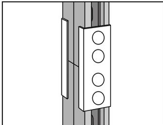
Le pendent 20 peut être rallongé à l'aide du profilé de suspension 24/20 et de l'éclisse d'assemblage 20J. Uniquement pour charges symétriques.
