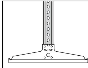
Le support console 3 est fixé à l'aide d'un set de montage 20S.
