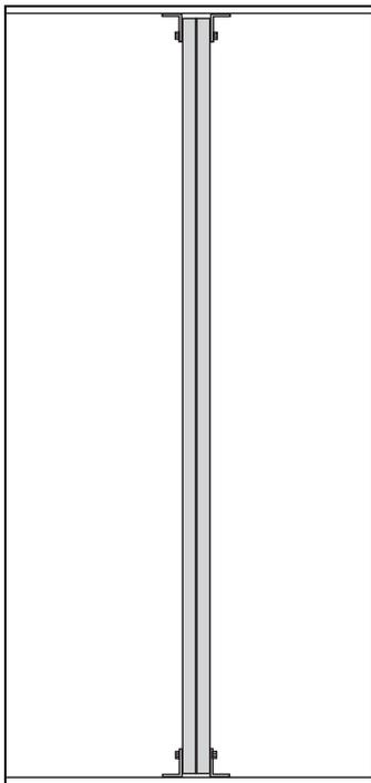
Le profilé de suspension 24/20 peut être calé entre le sol et le plafond à l'aide de 4 équerrés 5L et 4 boulons en T.
