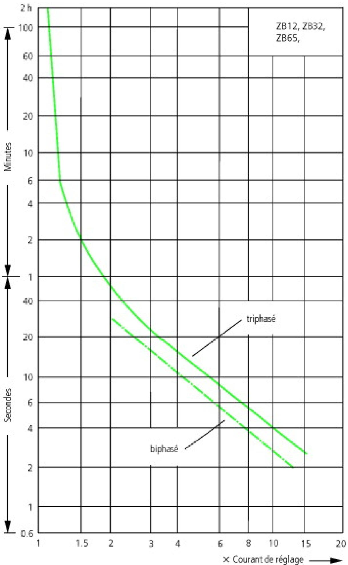
Ces courbes représentent les valeurs moyennes des bandes de dispersion à une température ambiante de 20 °C à partir de l'état froid. Temps de déclenchement en fonction du courant de réglage.
