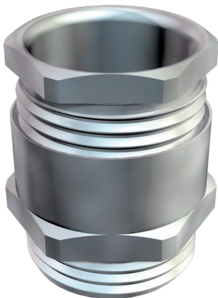
Presse-étoupe avec raccord intermédiaire à tête hexagonale, de forme C4 selon la norme DIN 46320 avec filetage PG selon la norme DIN 40430.
