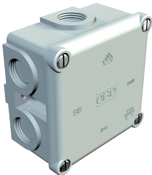
Classe de protection IP64, tension nominale 660 V, section nominale 2,5 mm<sup>2</sup>, 2 trous de fixation pour vis jusqu'à 5 mm Ø à l'extérieur du coffret, 4 vis de couvercle, 7 entrées défonçables avec filetage M20 x 1,5, de préférence pour presse-étoupes à filetage court. Dimensions intérieures : 80x80x39 mm.
