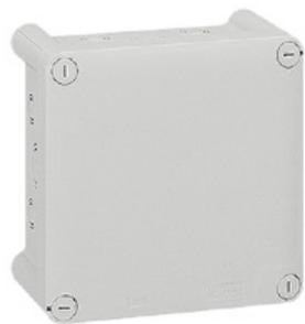
Boîte de dérivation carrée Plexo IP 55 - étanche - gris RAL 7035 - 20 entrées - fermeture du couvercle par 1/4 de tour - dimensions 130 x 130 x 74 mm
