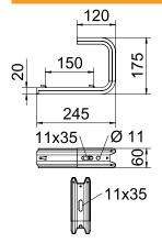
245,00 mm Largeur Dimension B 245,00 mm Dimension L 150,00 mm Exécution Étrier de suspension (étrier C) F sur plafond 0,80 kN F en kN (mur) 0,87 kN 200,00 - 200,00 mm pour largeur 200,00 mm Convient pour largeur de chemin de câbles/échelle de câble Convient pour le maintien de fonction Convient pour chemin de câbles Convient pour échelle à câbles Convient pour chemin de  $\checkmark$ câbles en treillis
