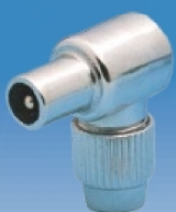
Fiche IEC 9.5mm coudée à 90° en zinc coulé, à visser, 100% blindée.
