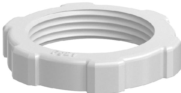
Contre-écrou selon la norme DIN 46320, avec filetage PG selon la norme DIN 40430.
