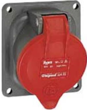
Socle de prise pour tableau Hypra - plastique - IP 44 - IK 09 - BT - 380-415 V - 16 A - 3 P + N + T - auto-extinguibilité 850 °C - temp. d'utilisation -50 à +100 °C
