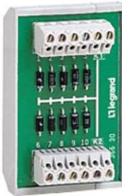
Module à diodes pour découplage de signaux ou collecteur d'informations - 10 diodes anode commune - fixation sur rail symétrique ou asymétrique
