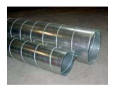
Les gaines de ventilation et les accessoires satisfont pleinement aux exigences mentionnées dans l'article C 14, caractéristique 105, édition 1990 de la Régie des Constructions. Les gaines sont construites au moyen de feuilles d'acier, suivant le respect des normes EN 10.142 et EN 10.143 avec une couche de zinc d'au moins  $275 \text{g/m}^2$  (soit une couche de 20  $\mu\text{m}$  d'épaisseur de chaque côté).
