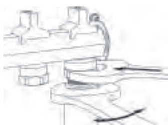
Raccordement des conduites de gaz sur les dérivationnelles
