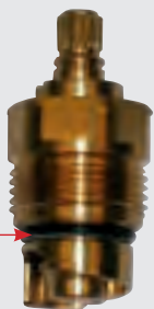
Présence d'une ligne de cercle = robinet petit Kv
