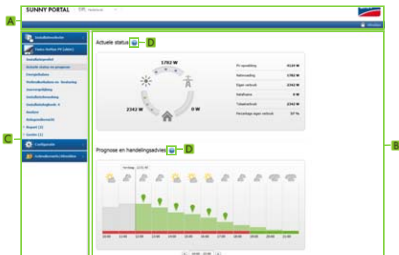
Afbeelding 2: Gebruikersinterface van de Sunny Home Manager-installatie in de Sunny Portal
