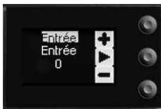
Une fois la saisie correcte du mot de passe effectuée à l'aide des touches + et -, le menu est activé et le capteur est prêt à être utilisé.
