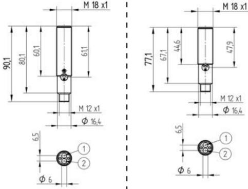
1 = Empfangsdiode/Receiver Diode/Diode réceptrice
